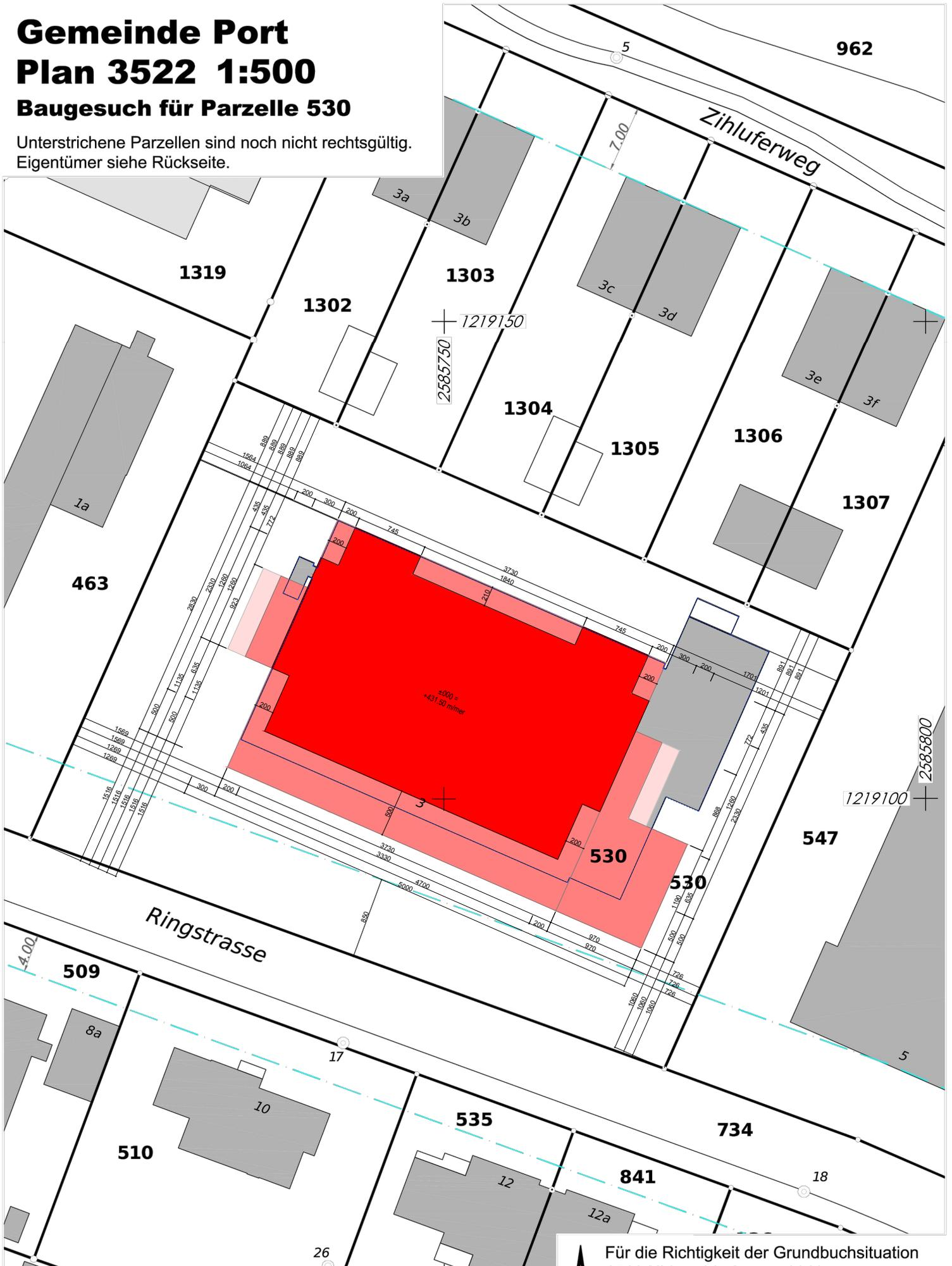
Daten aus der amtlichen Vermessung und Baulinien haben entsprechende Toleranzen. Müssen bei Projektierungen Abstände (z.B. Grenz-, Gebäude-, Strassenabstände, etc.) in cm-/dm-Bereich ausgenützt werden, so ist auf jeden Fall vorgängig im Feld zu messen, die Aktualität und bei Baulinien auch die Übereinstimmung mit den rechtsgültigen Plänen (z.B. ÖREB-Kataster) zu prüfen.
